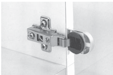
Scharnier CLICK vernickelt für Glastüre Öffnung 90° mit Bohrung Diam. 26 mm. Charnière CLICK nickelée pour portes vitrées ouverture 90° avec forage Diam. 26 mm.
